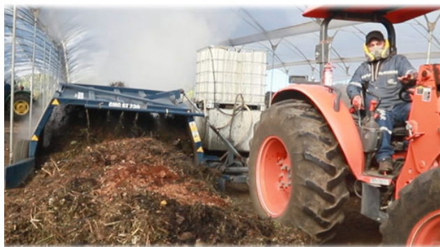
COMPOSTAJE LINEAL TECNOLÓGICO (TRACTOR, VOLTEADORA Y SISTEMA DE PERCEPCIÓN CON MICRO ORGANISMOS LOCALES)
