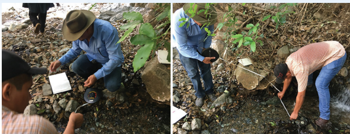
Ilustración 10. Medición de caudales, con participación de personal del MAGA y equipo ADPTATE/GIZ en la MC Las Ovejas, en Jícaro
