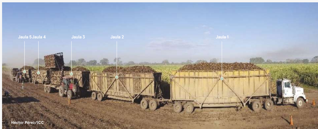
Figura 6-21 Equipo «penta» para el transporte de la cosecha de caña de azúcar a los ingenios
