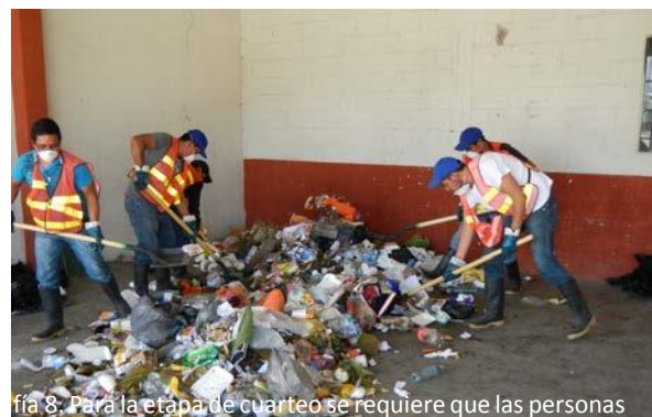
Figura 8. Para la etapa de cuarteo se requiere que las personas tengan su equipo de seguridad. Estudio de caracterización en el municipio de Quetzaltenango, por el MARN. Fotografía: Melissa Alvarez, 2014.
