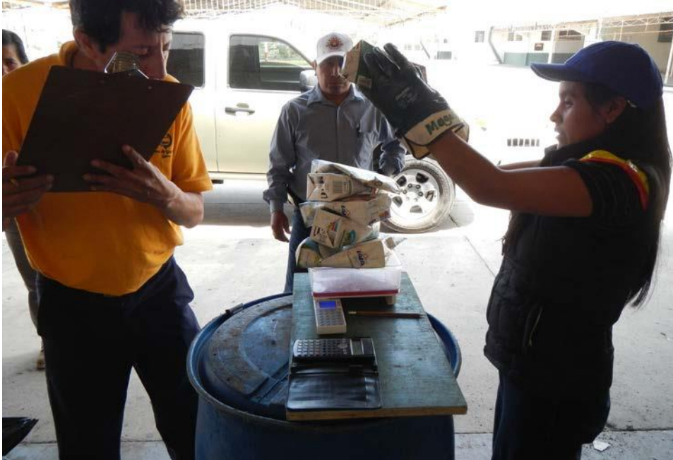
Fotografía 7. En el momento de pesar las muestras en los diferentes procesos las muestras deben descansar completamente dentro de la balanza y no deben tocar otra superficie ni ser sostenidas por el personal. Estudio de caracterización en el municipio de Quetzaltenango, por el MARN. Fotografía: Melissa Alvarez, 2014.
