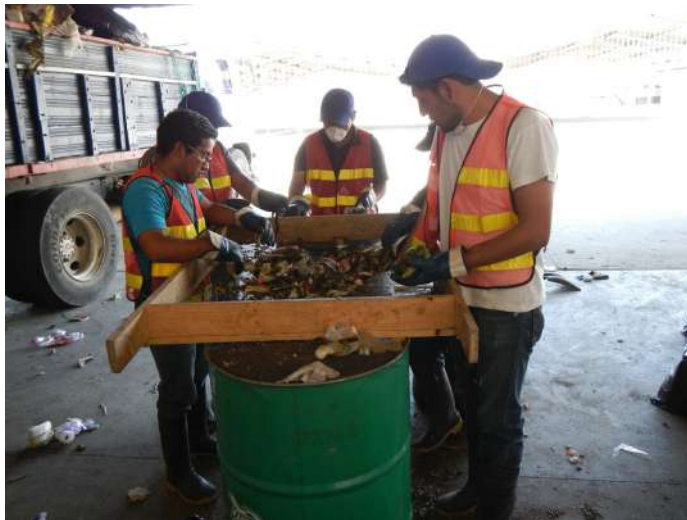
Fotografía 17 y 18. Se identifican dos momentos en la separación de los residuos y desechos, en la primera se separan los de mayor volumen posteriormente se barren los más pequeños y se colocan sobre el cernidor donde se requiere una mayor precisión y análisis. Estudios de caracterización en los municipios de Quetzaltenango y Amatitlán. Fotografía: Melissa Alvarez, 2014 y 2022.
