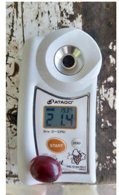
Medición de grados brix con refractómetro digital.
