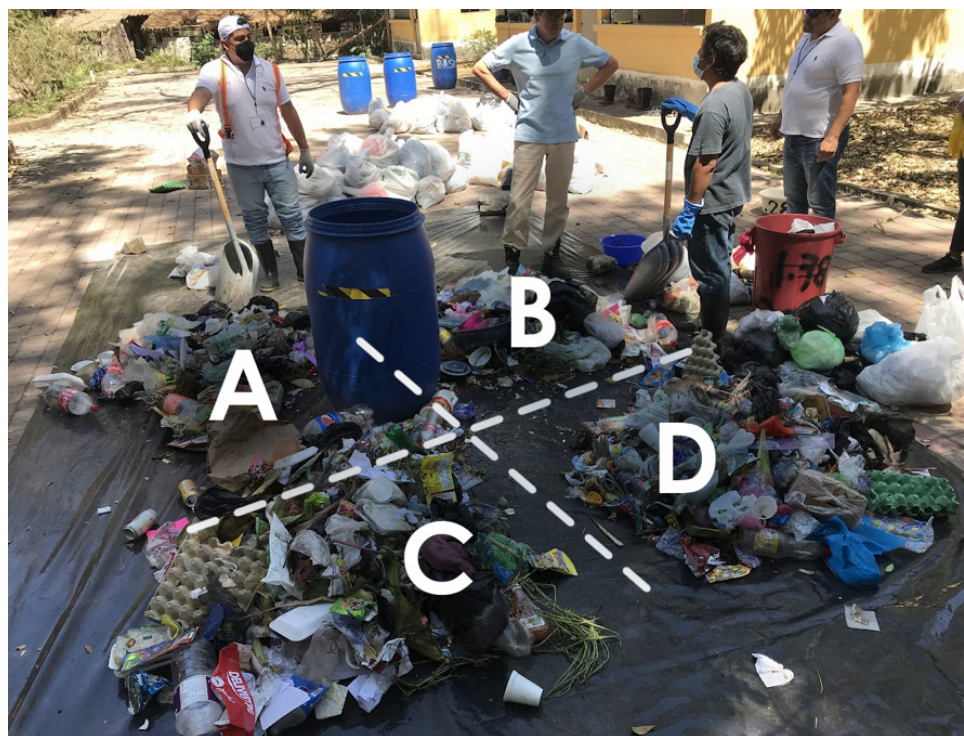
Fotografía 15. Después de realizar la prueba de densidad se vuelven a mezclar los residuos y desechos sólidos para realizar un nuevo cuarteo. En caso de ser reducida la muestra, se pueden volver a incluir los residuos y desechos utilizados en la prueba de densidad. El cuarteo concluye hasta que dos extremos sean suficientes para llenar un tonel. Como se muestra en la fotografía, se utilizan extremos opuestos para llenar el tonel, ya sea A y D o en su efecto, B y C. Fotografía: Alvarez, 2022
